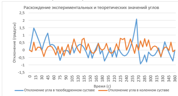
Рисунок 27 - Расхождение экспериментальных и теоретических значений углов при отработке реабилитационных движений.
